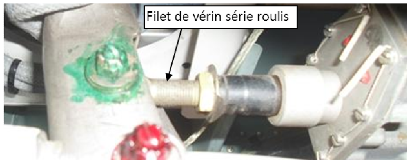
Extrémité droite de bielle du vérin série roulis
